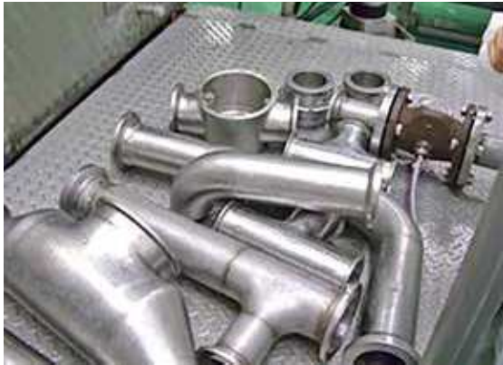
配管類の分解清掃
