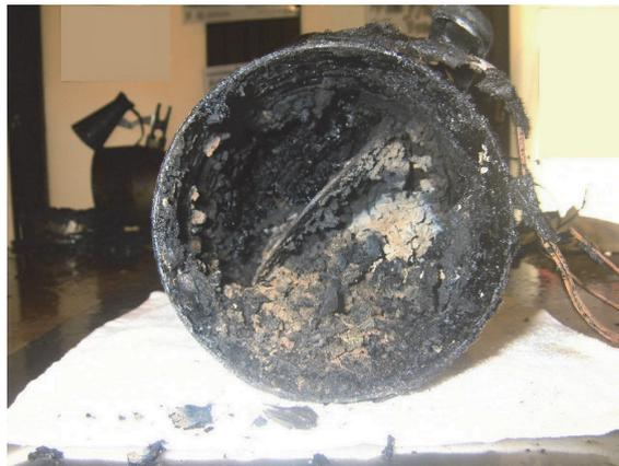
油塵が堆積し防火ダンパーが閉鎖していない
