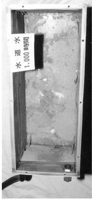
図1-I-2-0 蒸発槽内のスケールの堆積
