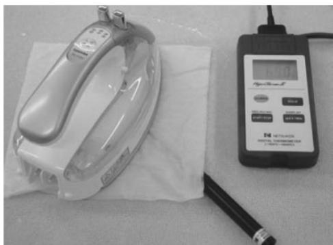
写真 7 スチームアイロンによる加熱におけるカーペット表面の温度測定
