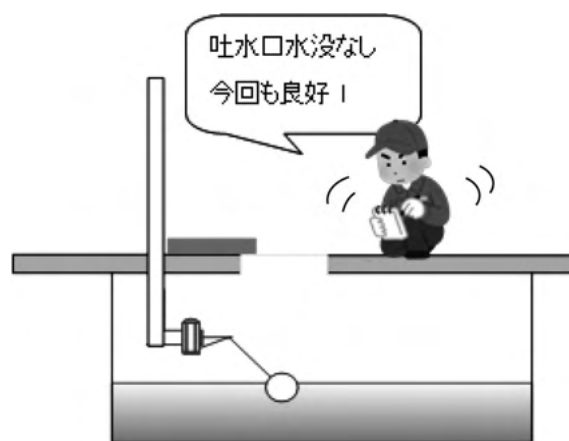
図 10 吐水口の状態を確認
