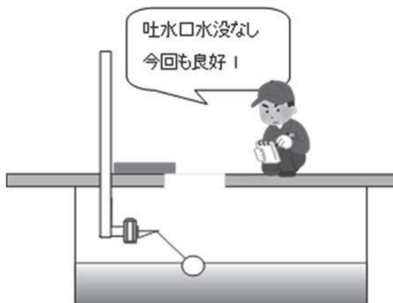
図 8 吐水口の状態を確認
