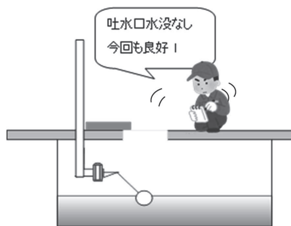
図 8 吐水口の状態を確認
