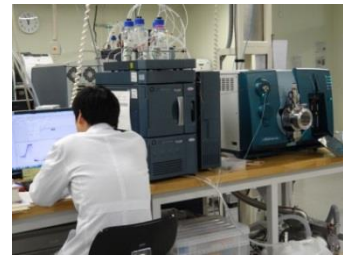
LC-MS/MSで農薬を測定する
