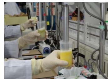
ホモジナイザーで農薬を溶かし出す
