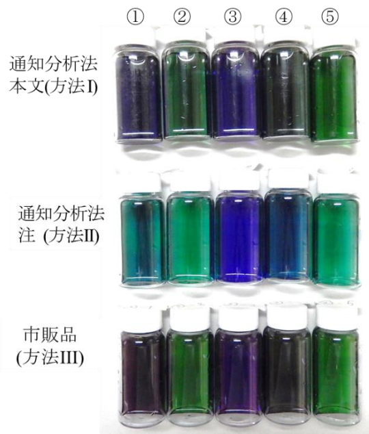
① 0.3%過酸化水素溶液に指示薬を添加したもの ② 5倍希釈した0.01 mol/L水酸化ナトリウムを添加したもの ③ 0.01 mol/L硫酸を添加したもの (蒸留後の状態) ④ 変色点 ⑤ 終点
