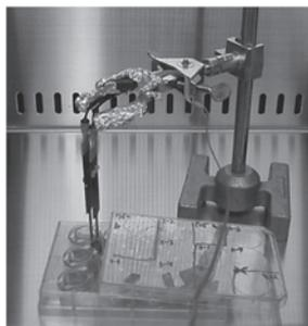
写真2 電極の固定
