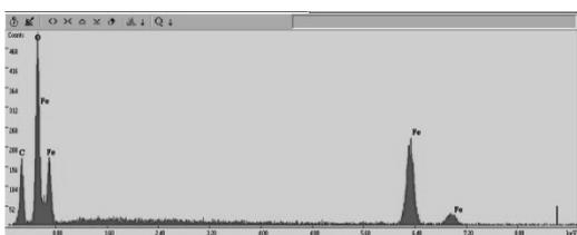
図1. 球状粒子(2)のEDS分析結果
