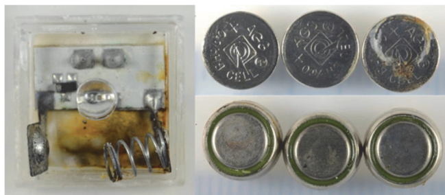
図6. LEDキューブライト内の基板とボタン電池の状態
