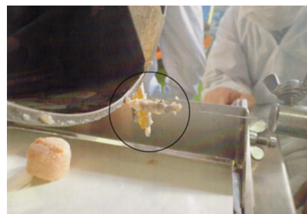
写真11. 肉団子の成形機の切り取り部に付着した汚れ
