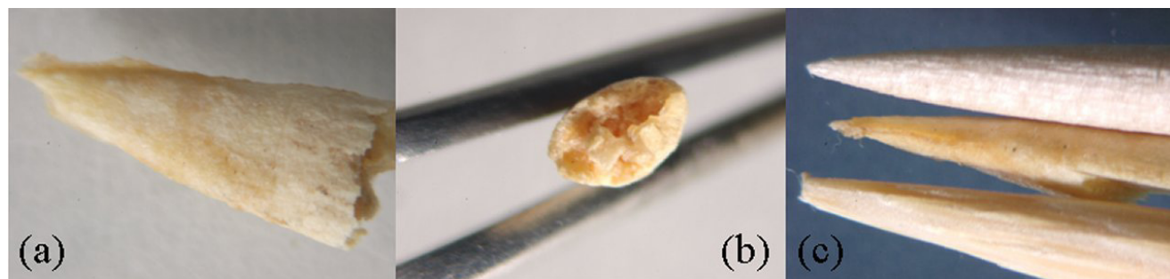
写真2. 食パン中に混入していた淡黄色固形物と竹串
