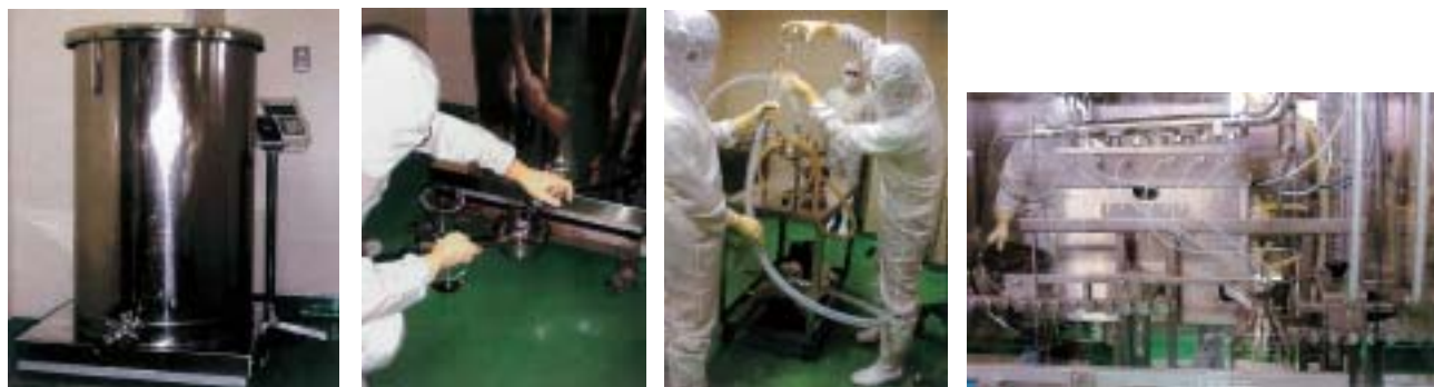
a 液調製用タンク b リンス液の回収 c ポンプから ろ過器のリンス d 6本の充填針より採取
