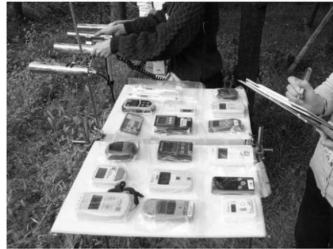
図7. サーベイメータと簡易型線量計の性能比較テスト
