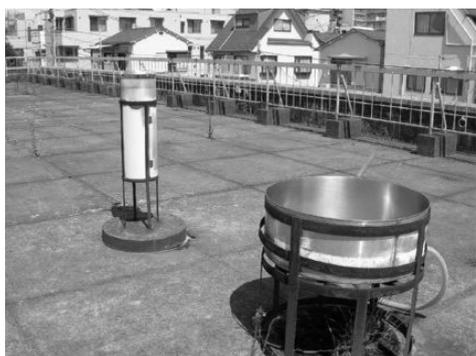
図3. チェルノブイリ原発事故当時の大型水盤と全ベータ測定用雨水採取装置
