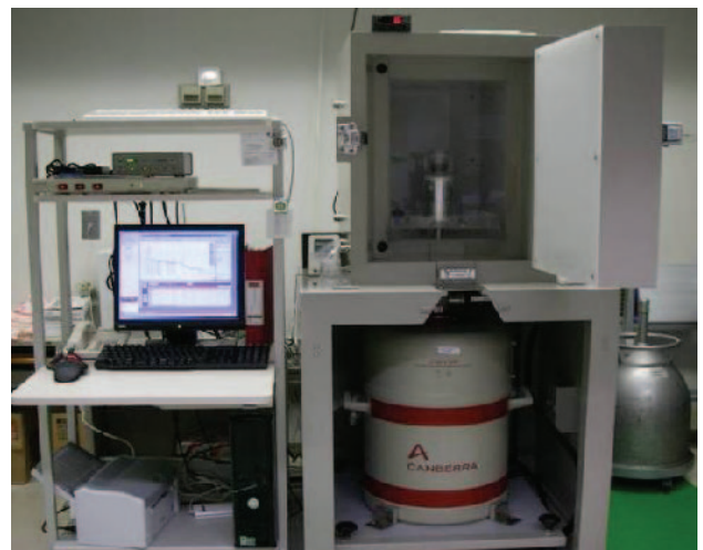
写真2 ゲルマニウム半導体検出器(液体窒素循環冷却装置付き)
